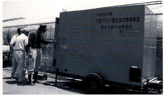
写真2 平成15年度 事業導入により4戸で共同購入した熱水土壌消毒機
