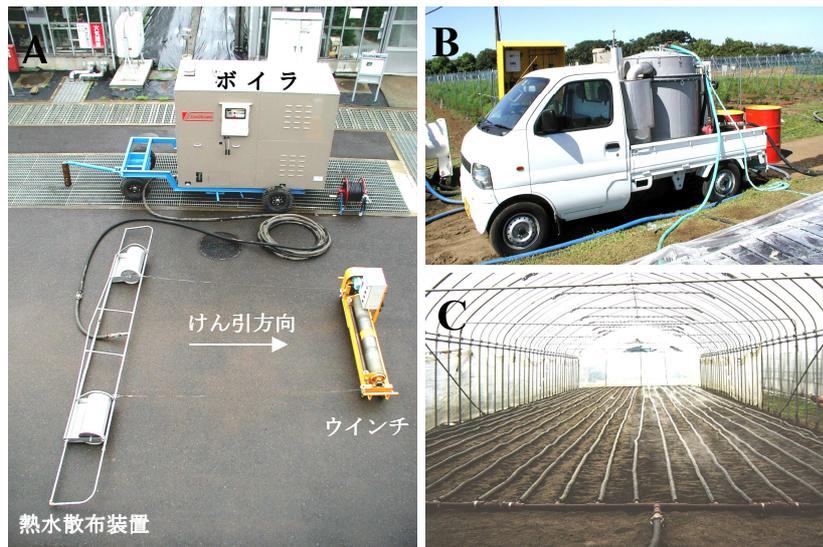
図2 熱水土壤消毒装置のシステム構成
